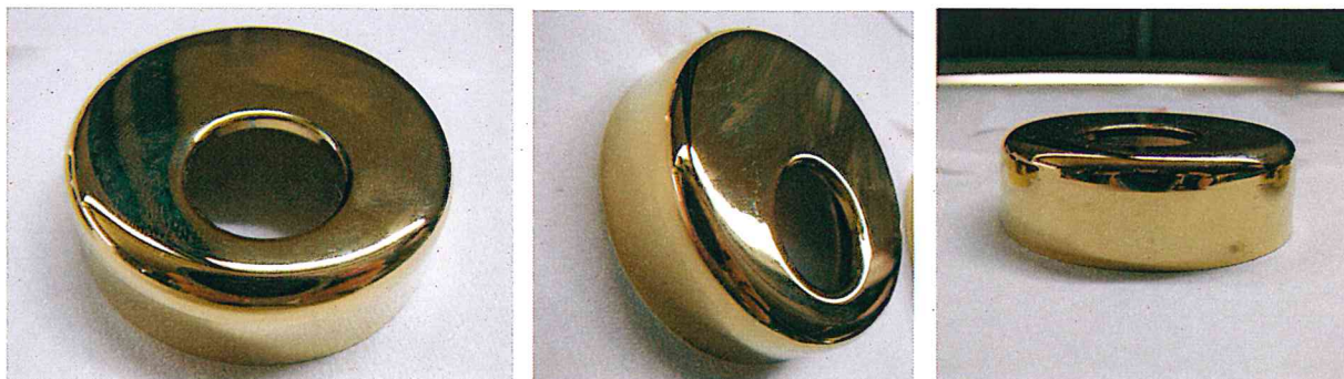
Superficie del campione dopo 240 ore di esposizione e dopo la pulizia dei residui salini superficiali.
